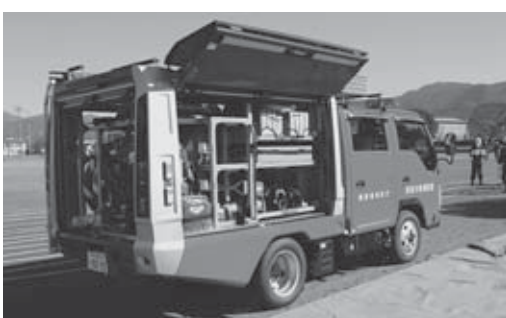
小型動力ポンプのほか、AEDや油圧ジャッキ、チェーンソーなどが装備された積載車
